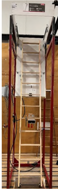
Figure 3: Torsion test setup / Torsionsversuchsaufbau
